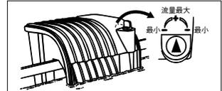
7 フィルターケースが水槽の外側になるように水槽枠にセットし、流量調節つまみを+ (プラス) 側に回し、流量が最大になるように調節します。
